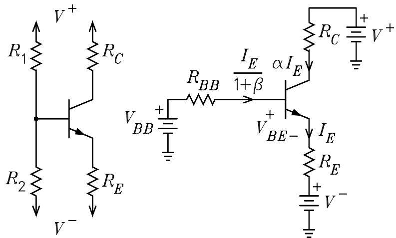
$$V_{BB} := \frac{V_{plus} \cdot R_2 + V_{minus} \cdot R_1}{R_1 + R_2} \quad V_{BB} = 1.364$$
