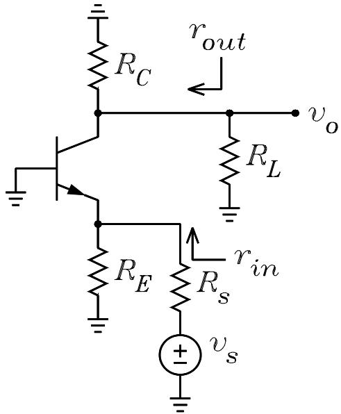
$$v_{te} := v_s \cdot \frac{R_E}{R_S + R_E} \quad v_{te} = 0.982$$
