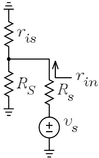
$$r_{is} := r'_s \cdot \frac{r_0 + R_{td}}{r_0 + r'_s} \quad r_{is} = 363.932$$
